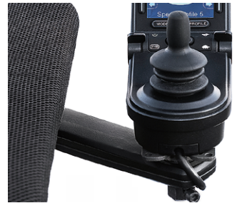
Mecanismo encapsulado para abatir el mando // QML110056
